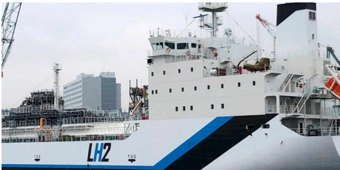
Conçu par Kawasaki Heavy Industries, le Suïso Frontier est le premier navire transporteur d'hydrogène au monde. Il peut transporter 75 tonnes d'hydrogène liquide refroidi à - 253 degrés Celsius. (Crédits : Reuters)
